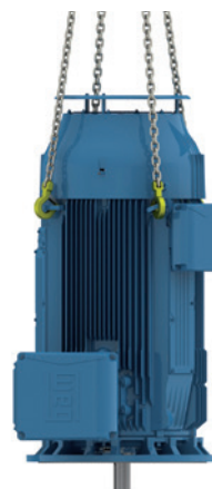
Figure 9 - Levage de moteurs verticaux.
